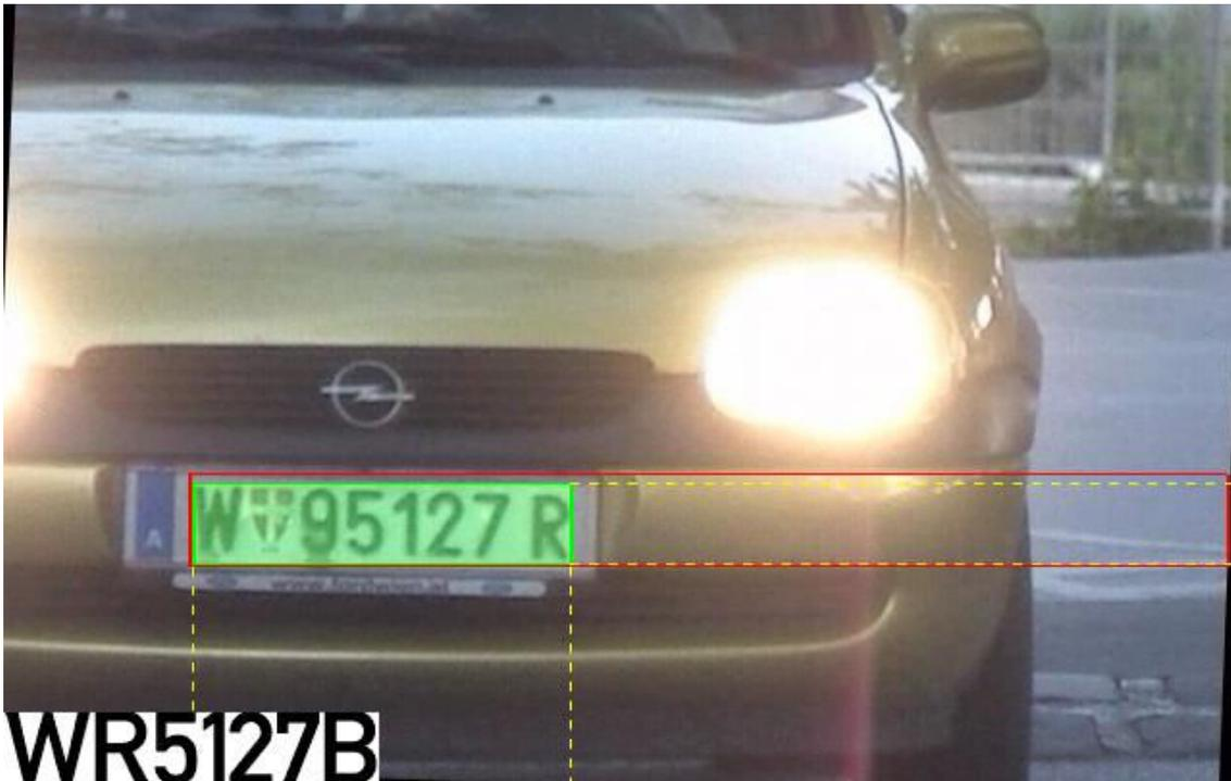
**Abbildung 13: Falsche Klassifikation durch verdrehtes Kennzeichen**
