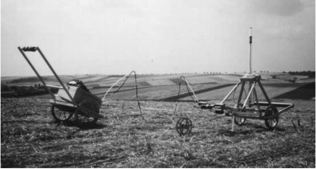
Abbildung 1: links: Begleitwagen mit Meßgerät, Datenaufzeichnungsgerät und Stromversorgung; rechts: Meßwagen mit Sensoren und Meßwertauslöser
