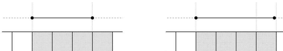
Abbildung 4.1: Es werden minimal  $\lfloor u \rfloor + 1$  Pixel gefärbt
