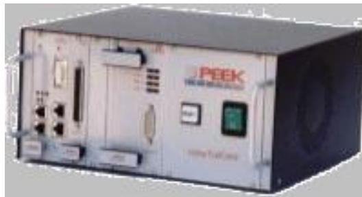
Abbildung 3.4: Das Bild zeigt die VideoTrak Basisstation.
