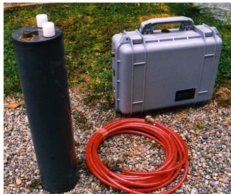
Abbildung 1.5: Dual-axis Magnetometer (schwarzes Gerät) und Installationskit
