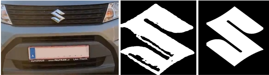
Abbildung 1: v.l.n.r.: Frame aus Eingabe, zugeschnittenes Kantenbild, zugeordnetes Logo
